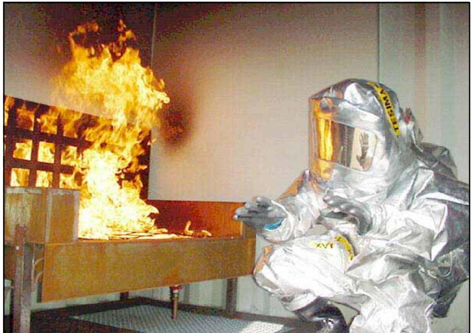
als CSF (C = Chemikalienschutz, S = Sichtscheibe, F = Feuerwehr). Bei der Prüfung wurde er auch rund 20 Minuten lang bei Heißdampf mit einer Dampfaustrittstemperatur von rund 350°C getestet. Eines muss man allerdings sagen: Er kann nicht den herkömmlichen Hitzeschutzanzug ersetzen. Gegenüber dem „alten“ CSA hat er aber deutliche Vorteile, wenn neben der Gefährdung durch flüssige oder gasförmige Chemikalien noch die Bedrohung durch plötzlich auftretende Stichflammen hinzu kommt.
