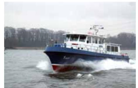
»WSP 1« wird auch als Ausbildungsboot und schwimmende Befehlsstelle bei Großveranstaltungen eingesetzt. Länge: 19,00 m, Breite: 5,30 m und Tiefe: 1,20 m, Leistung: 2 x 552 kW.
