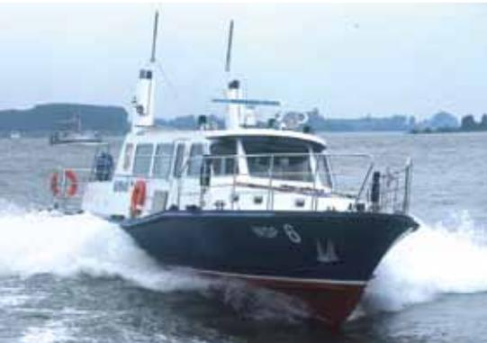
Ein modernes Rheinstreifenboot, 17,75 m lang, 4,53 m breit und mit 2 x 370 kW fast 50 km/h schnell.
