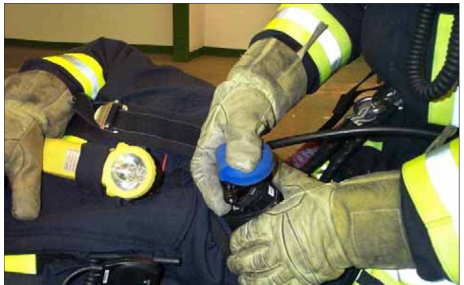
Abbildung 8: Sollte es Probleme beim aufschrauben des Rettungslungenautomaten geben, kann dem verunfallten FA durch drü- cken des Druckentlastungsknopfes Luft zugeführt werden.
