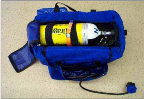
Die Aufsatztasche ist durch eine Öffnung im inneren mit der Innentasche verbunden. Der Rettungslungenautomat ist so, betriebsbereit mit dem PA
