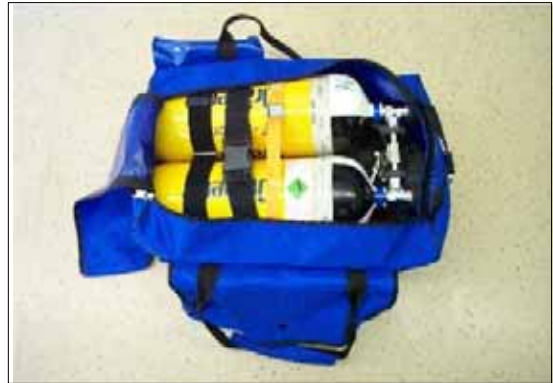
Rettungspack mit LPA. Nach der Zusammenstellung des Rettungspacks muss eine Hochdruck-Kurzprüfung durchgeführt werden.
