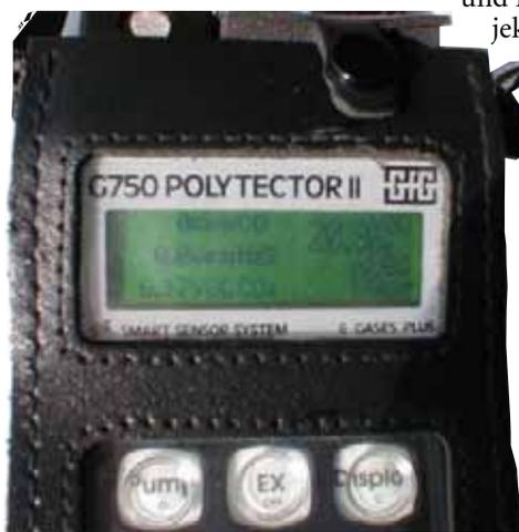
Der neue Polytektor im Messkoffer auf den C-Dienst-ELW kann fünf Messungen gleichzeitig durchführen. So werden der Gehalt von Kohlenmonoxid, Kohlendioxid, Schwefelwasserstoff und Sauerstoff in der Umgebungsluft gemessen, zusätzlich wird noch die untere Explosionsgrenze überwacht und angezeigt. Auch die Bedienung ist einfach
