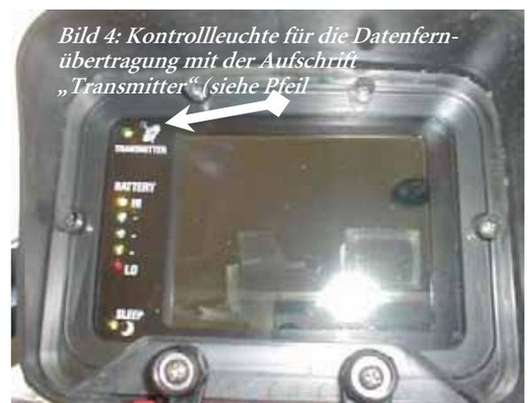
Bild 4: Kontrollleuchte für die Datenfernübertragung mit der Aufschrift ‚Transmitter‘ (siehe Pfeil)
