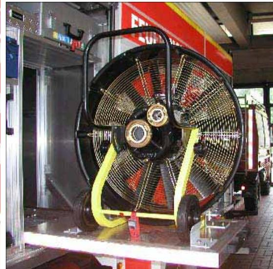
Überdrucklüfter mit Wassermotor
