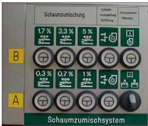
Bild links: Die Schaummittelzumischung erfolgt ganz einfach über Druckschalter
