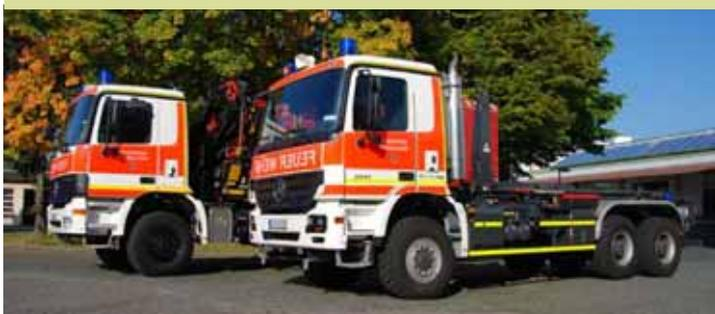
Die Fahrzeuge haben eine deutliche bessere Traktion bei schwierigen oder glatten Straßenverhältnissen. Auch ein schmieriger Untergrund führt nicht zwangsläufig zum „Antriebsausfall“ wie bei Standardantrieben. Dazu kommt die höhere Bodenfreiheit gegenüber der Straßenantriebsversion. Dadurch werden Fahrten wie zum Beispiel durch Wasseransammlungen möglich, ohne dadurch Schäden am Fahrzeug zu hinterlassen. Das Maß dafür nennt der Fachmann eine größere Wadfähigkeit.
