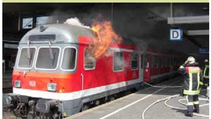
Brand im Steuerstand eines S-Bahn-Zuges
