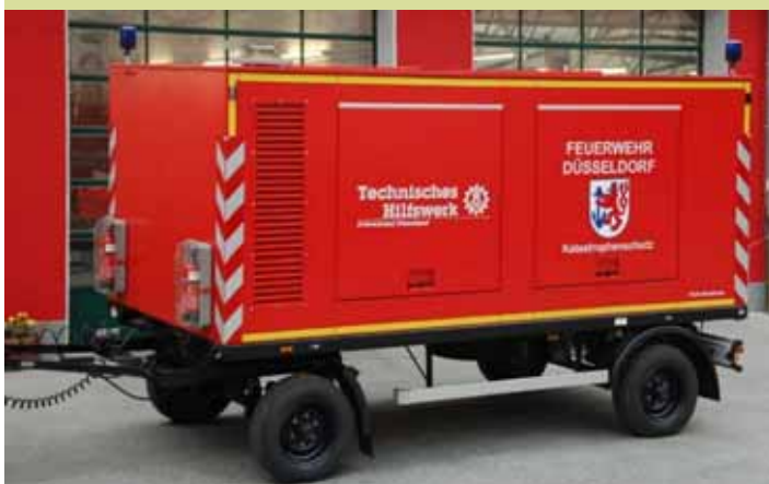
Die neue Netzersatzanlage
