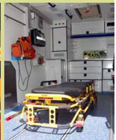
Die Krankentrage ist mit 725 Kilogramm belastbar.
