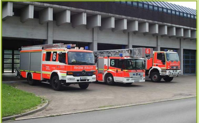
Die jetzt fest besetzten Fahrzeuge einer Gruppenwache: Löschgruppenfahrzeug, Drehleiter und Tanklöschfahrzeug
