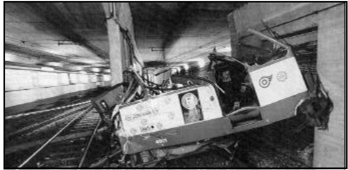
Durch die Wucht des Aufpralls wird ein Wagen der U 77 an einem Pfeiler wenige Meter vor dem Hauptbahnhof in zwei Teile gerissen. Es wird niemand verletzt, weil die Bahn noch leer ist.
