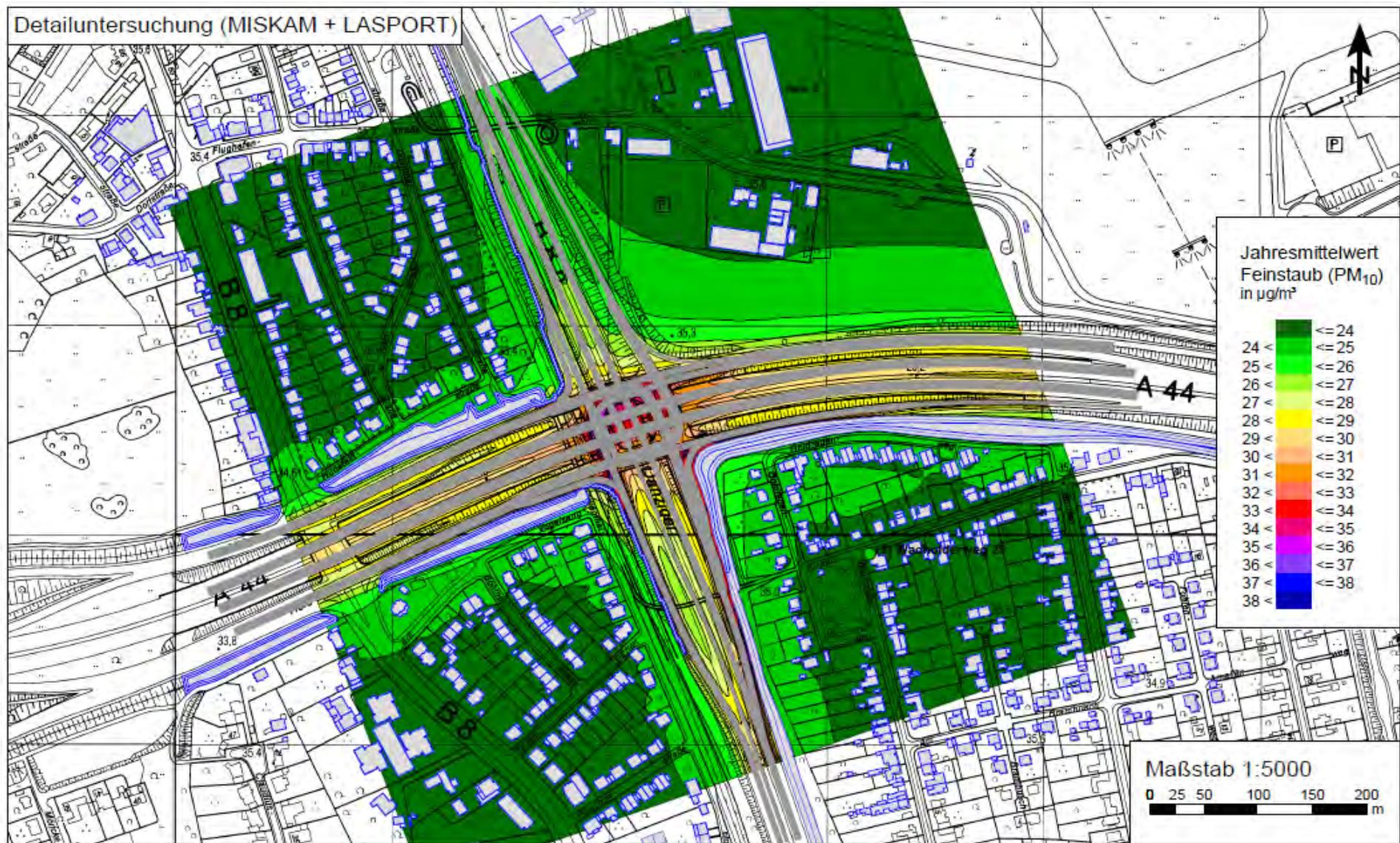
Abb. 15: Feinstaub-Belastung bestehend aus Hintergrund, verkehrlicher Belastung sowie Flughafen-Immissionen; Methodisch: MISKAM; Beurteilung: 39. BImSchV; Quelle PEUTZ
