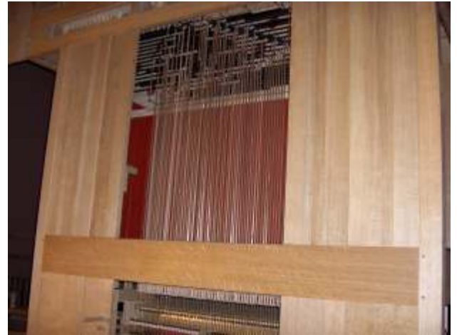
Traktur, Verbindung von Taste und Pfeifenventil
