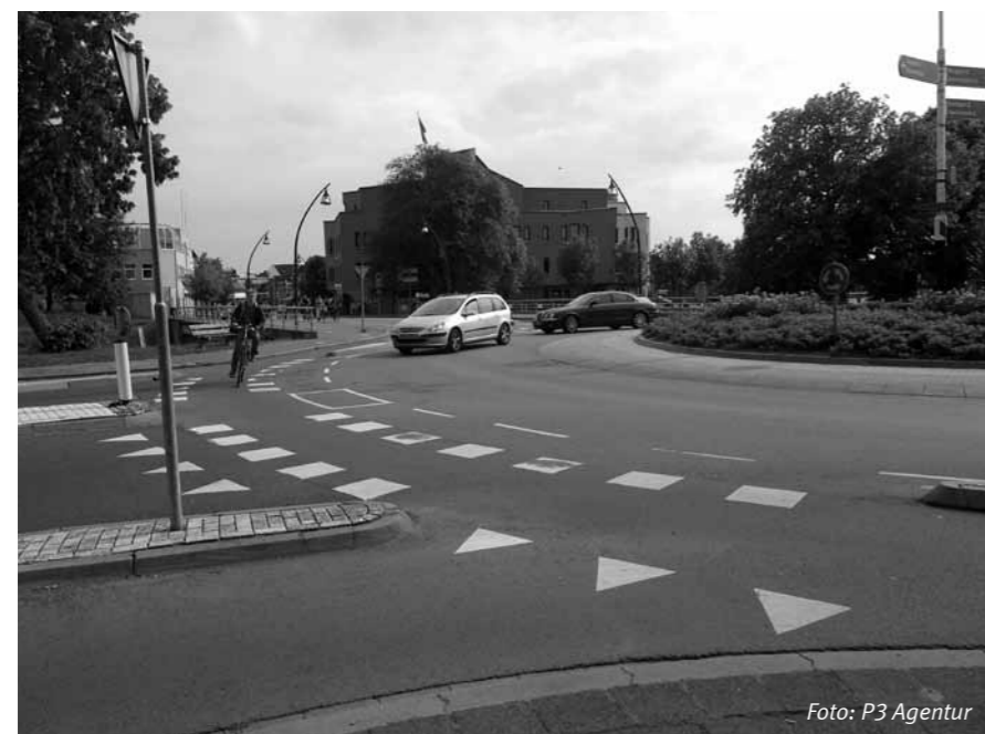
Zentral gelegener Kreisverkehr mit fahrbahnseitiger Radverkehrsführung
