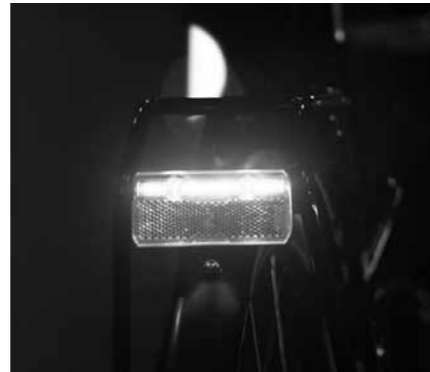
Das neue BrakeTec von Busch + Müller leuchtet auf, sobald der Radfahrer langsamer wird.
