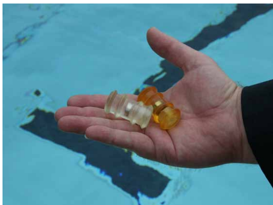
So genannte ‚Molche‘ reinigen die Rohre von innen. (Foto: EUREGIO)
